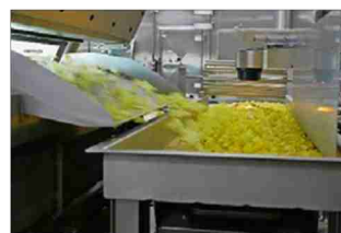
Der Optisorter selektiert die zu dunklen Chips.
